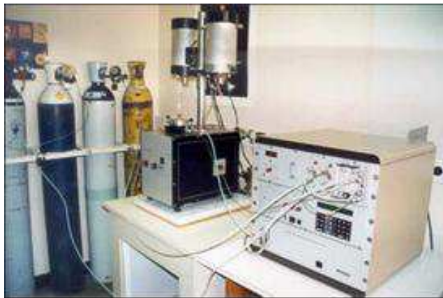
Figure II-14 : Vue d'ensemble de la STA 409 E de Netzsch
