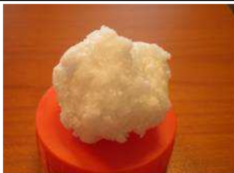
Figure III-3 : Pâte de ciment phosphomagnésien formée avec de la magnésie calcinée à 1500°C pendant 24 heures ( MgO/KH_2PO_4 = 1 et E/C = 0,20 )
