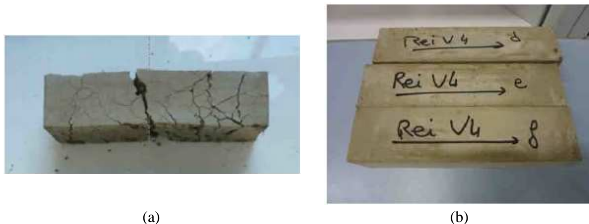
Figure V-14 : Photographies de CEM I contenant des résines de \text{Na}^+ sous forme de billes après le démoulage réalisé à 7 jours (a) et à 14 jours (b) [10]
