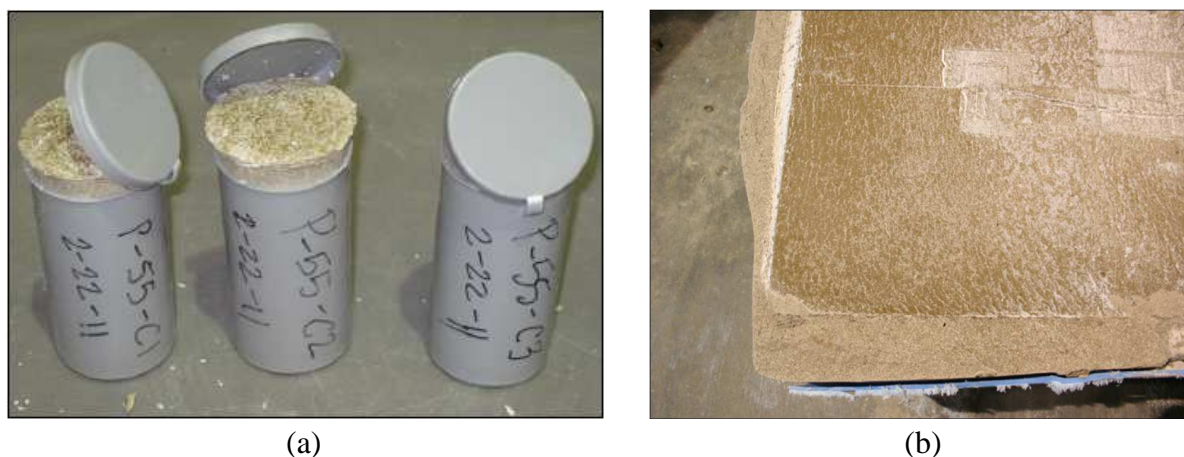
Figure V-13 : Enrobés cimentaires (a) dans des moules et (b) dans un colis de déchets [8]
