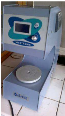
Figure II-6 : Appareil Vicatronic pour la mesure de prise Vicat et un échantillon en cours d'essai.
