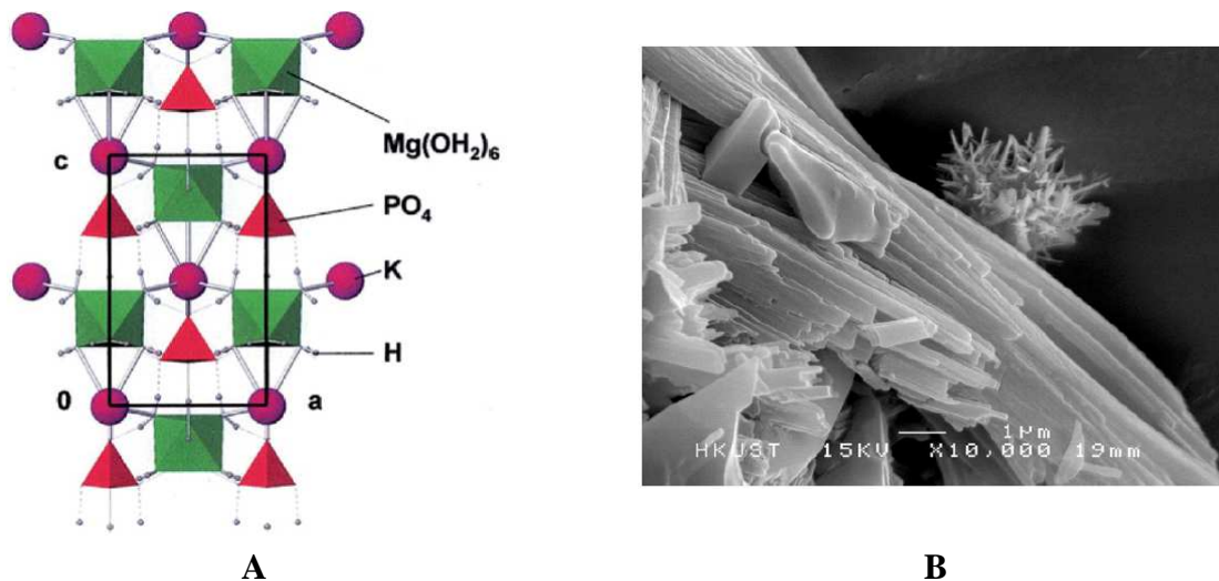
Figure I-12 : (a) Structure d'un cristal de k-struvite, projeté le long de l'axe [010] et montrant les liaisons hydrogène [51]; (b) Image MEB de cristaux de k-struvite [40]
