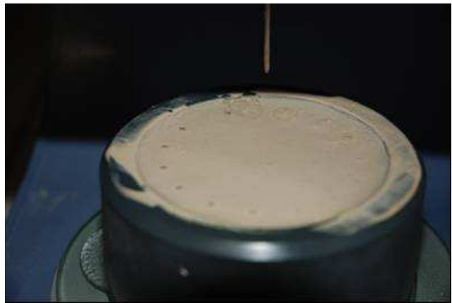
Figure II-6 : Appareil Vicatronic pour la mesure de prise Vicat et un échantillon en cours d'essai.
