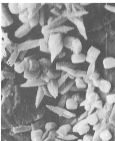
Figure I-15 : Image MEB des cristaux de dittmarite [47]
