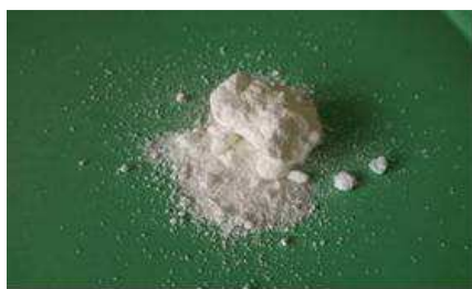
Figure III-1 : Essai de prise avec une magnésie pure non traitée (Rapport molaire MgO/KH_2PO_4 = 1 , rapport massique E/C = 0,20)
