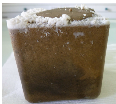
Figure IV-25 : Efflorescence à la surface de l'échantillon réalisé avec un rapport Mg/P = 3
