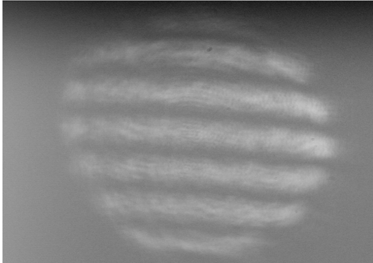
Figure [II.27]. Image de la figure d'interférence entre les deux faisceaux sur l'échantillon obtenue en défocalisant l'objectif O2
