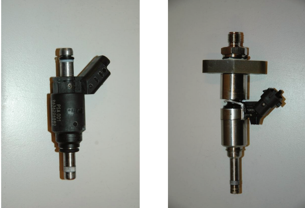
Figure 23. Photographies de l'injecteur monotrou (à gauche) et de l'injecteur 7 trous (à droite)
