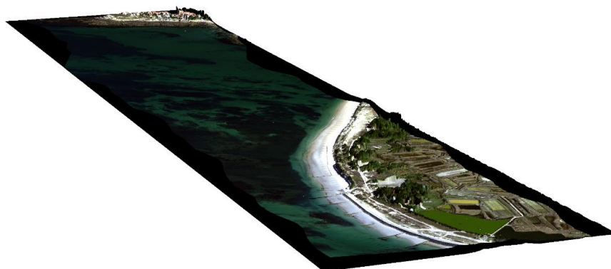
Figure 10 : Image hyperspectrale 3D issue du drapage de l'image HSI sur le MNE issu du LiDAR. Ce type d'image donne accès à une information en 4D, utile dans différents domaines type génie civil et côtier.
