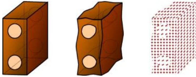
Figure 1.4. Illustration du modèle nominal, skin model continu et discret [34]
