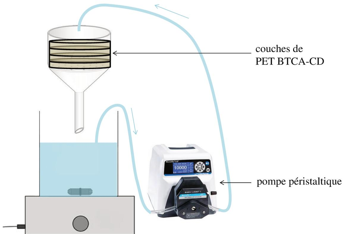
Figure 51. Schéma du montage expérimental d'un système dynamique pour les tests d'adsorption utilisant le PET BTCA-CD.
