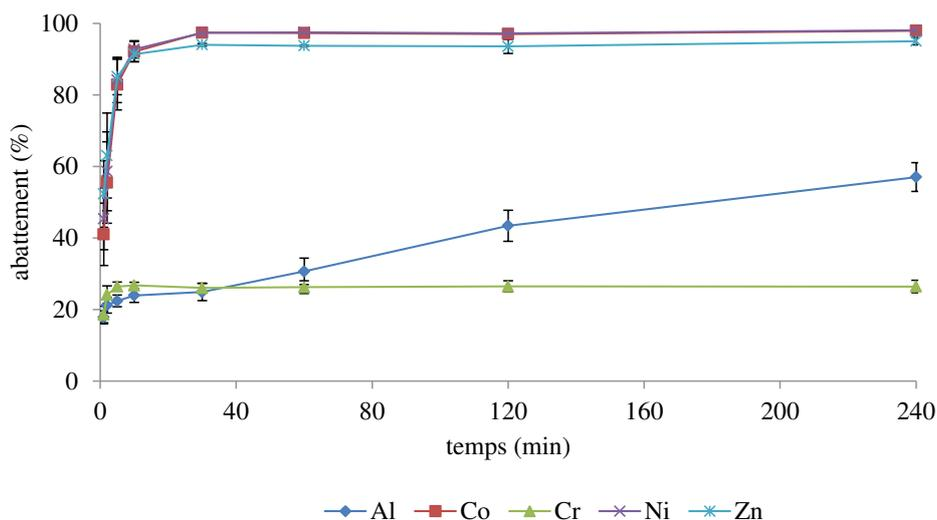
Figure 92. Cinétique d'adsorption (en pourcentage d'abattement) du PET BTCA-CD basique (dose : 2 g L<sup>-1</sup>) pour une solution polymétallique contenant 5 métaux (1 mg L<sup>-1</sup>) (n = 3).
