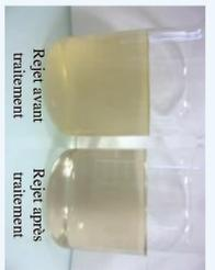
Élimination des métaux sous forme particulaire par le système de filtration
