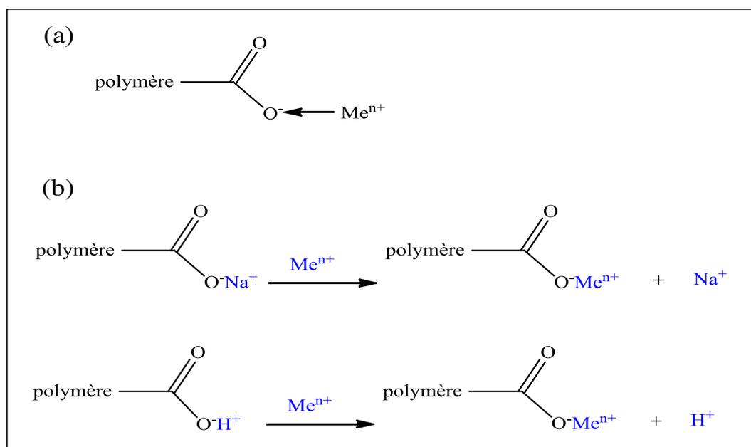
Figure 90. Interactions possibles entre les substances inorganiqués et les matériaux-CD (a) interaction électrostatique, (b) échange d'ions.
