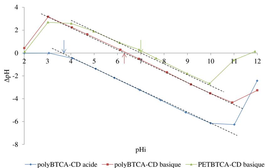
Figure 70. Détermination du  $pH_{pcn}$  pour les différents matériaux.
