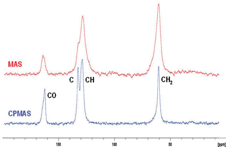
Figure 79. Comparaison des spectres MAS et CPMAS du PET brut.
