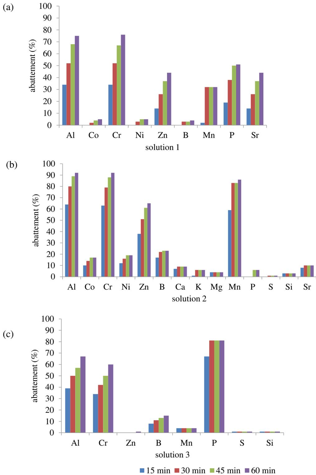
Figure 99. Abattement (%) en fonction du temps pour (a) solution 1 ( $pH_i = 7,9$  ;  $pH_f = 8,2$ ) traitée par le filtre poche Te1, (b) solution 2 ( $pH_i = 7,4$  ;  $pH_f = 8$ ) traitée par le filtre poche CD1 et (c) solution 3 ( $pH_i = 5,1$  ;  $pH_f = 6$ ) traitée par le filtre poche CD2.
