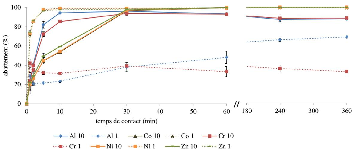
Figure 91. Cinétique d'adsorption (exprimée en pourcentage d'abattement) pour le polyBTCA-CD basique (dose : 2 g L<sup>-1</sup>) pour deux solutions contenant 5 métaux à deux concentrations (solution à 10 mg L<sup>-1</sup> : lignes pleines ; solution à 1 mg L<sup>-1</sup> : lignes en pointillés) (n = 3).
