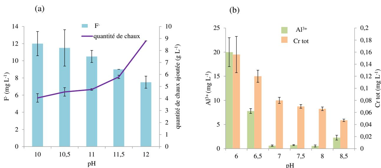
Figure 65. Évolution des concentrations (mg L<sup>-1</sup>) en fonction du pH pour (a) fluorures (temps de contact : 90 min ; agitation : 200 rpm ; effluents bruts : pH = 3,3 ± 0,1 ; [F] = 500 ± 71 mg L<sup>-1</sup>) et (b) aluminium et chrome ( temps de contact : 90 min ; agitation : 200 rpm ; effluents bruts : pH = 3,3 ± 0,1 ; [Al] = 180 ± 42 mg L<sup>-1</sup> ; [Cr tot] = 33 ± 7 mg L<sup>-1</sup>) (n = 3).
