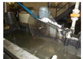
Figure 15. Déshuilage dans un bain de traitement.
