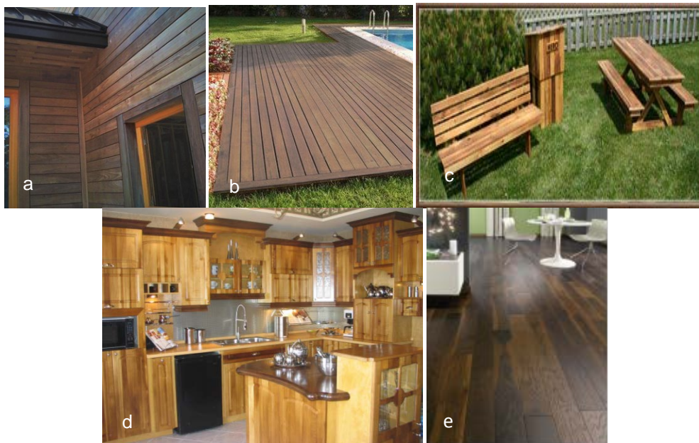
Figure 3 : Exemples d'applications du bois traité thermiquement a) bardage, b) bords de piscine, c) mobilier de jardin, d) lambris, e) parquet
