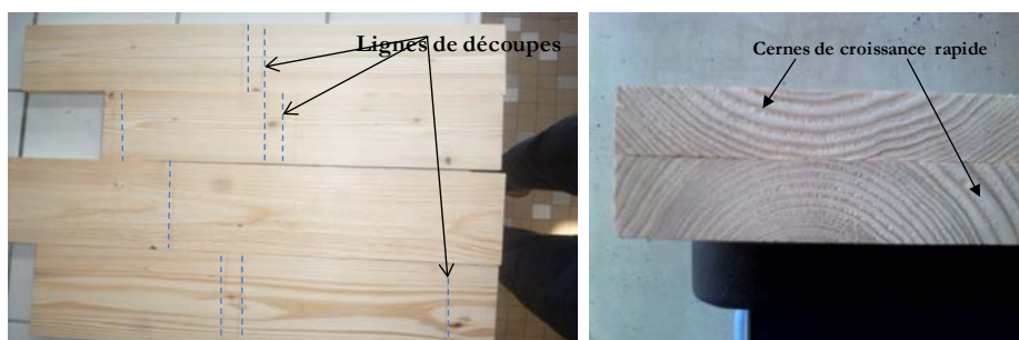
Figure 40 : Photos montrant des planches de sapin pectiné avec les lignes de découpes des nœuds à gauche et les cernes de croissance rapide à droite
