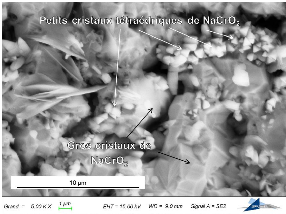
Figure 5.14 – Observation MEB (électrons secondaires, tension d'accélération : 15 kV) d'une surface exposée au sodium liquide contenant 200 \mu\text{g}\cdot\text{g}^{-1} d'oxygène pendant 5304 h à 550^\circ\text{C} .
