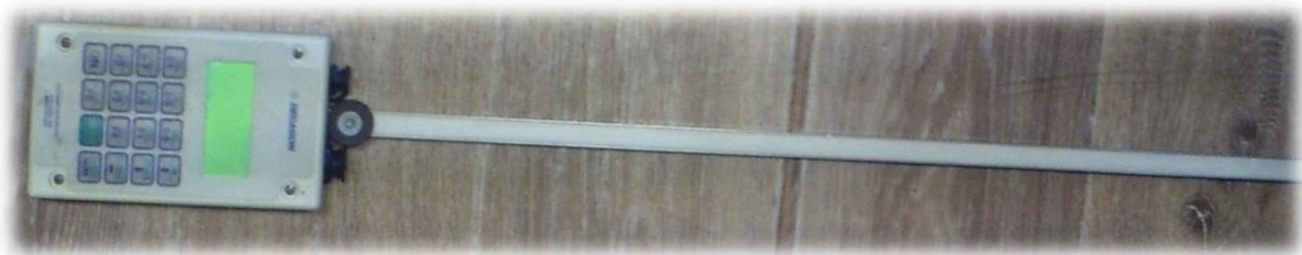
Photo 4. Ceptomètre modèle PAR-80 utilisé pour la caractérisation de l'environnement lumineux dans le dispositif en conditions semi-contrôlées PépiRoCh.
