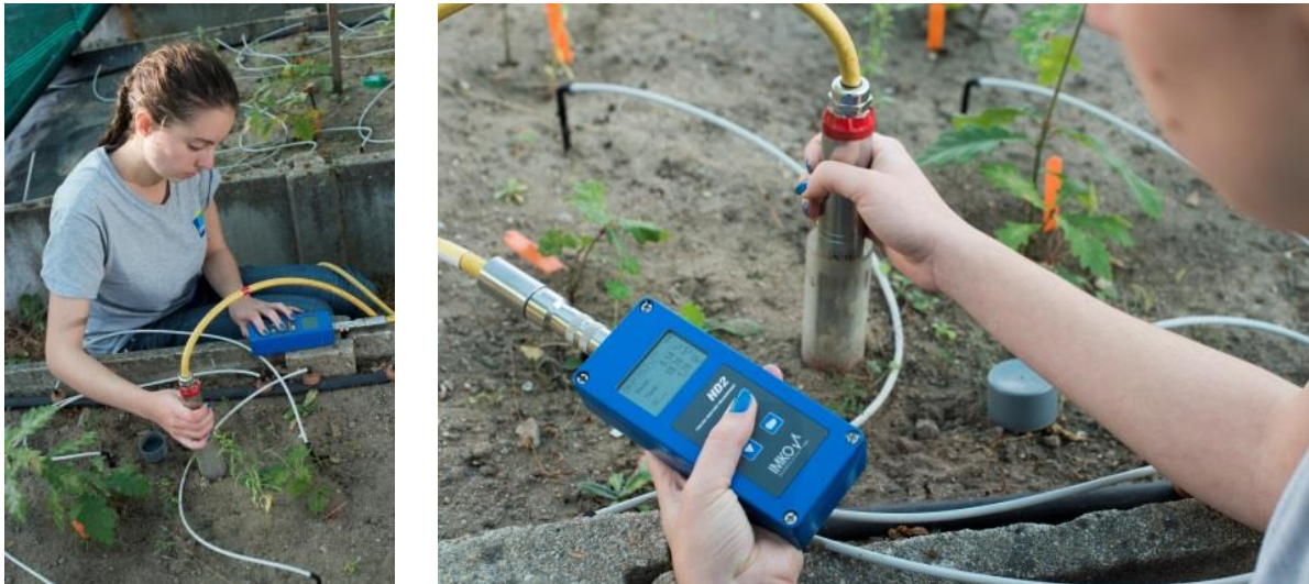
Photo 3. Mesures d'humidité relative du sol grâce à une sonde TDR de type TRIME-pico IPH.
