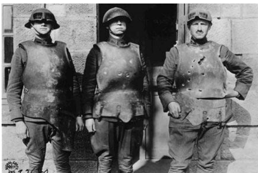
Figure 3 : Armures « Brewster Body Shield » faites d'un alliage de chrome et de nickel datant de la Première Guerre Mondiale (à gauche) _ Gilet pare-balle composé de huit plaques en Duron datant de la Seconde Guerre Mondiale (à droite)
