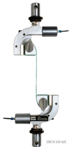
Figure 1.9: Illustration de mors classiques pour maintenir des fils sur machine de traction quasi-statique [45].
