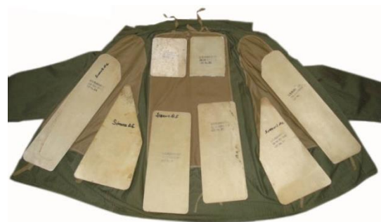
Figure 3 : Armures « Brewster Body Shield » faites d'un alliage de chrome et de nickel datant de la Première Guerre Mondiale (à gauche) _ Gilet pare-balle composé de huit plaques en Duron datant de la Seconde Guerre Mondiale (à droite)
