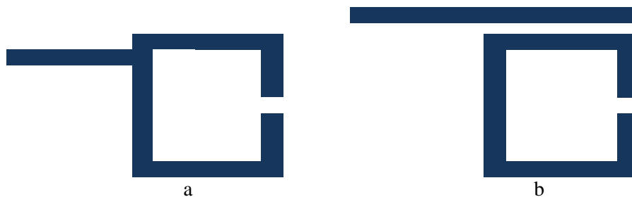
Figure 4.23 Types d'alimentation pour les résonateurs en boucle ouverte
