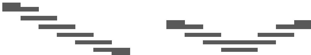
Figure 1.17 Filtres planaires à lignes couplées [27]
