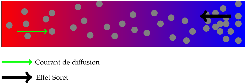
FIGURE 1.7 – Schéma de l'effet Soret [11]
