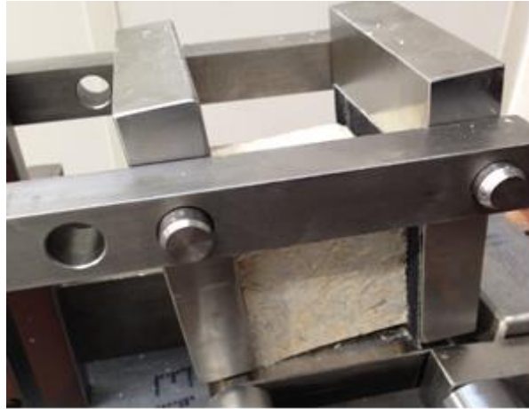
Figure 3-2 : Montage avec papier abrasif, décollage de l'éprouvette
