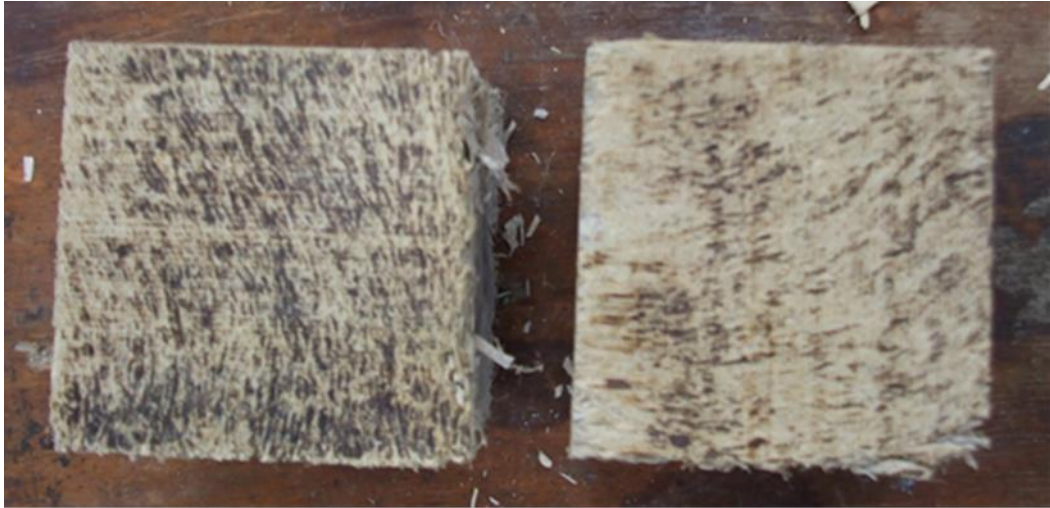
Figure 2-10 : Cube M4 à gauche, M1 à droite (70*70*70 mm)
