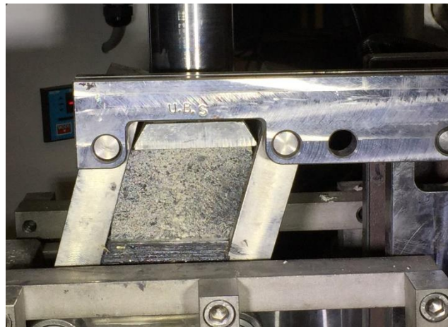
Figure 3-3 : Dispositif expérimental de cisaillement sélectionné
