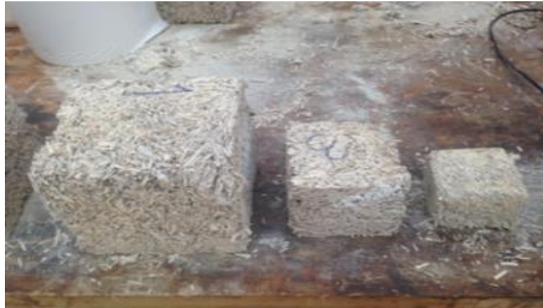
Figure 2-26: Cubes de Chanvribloc® de tailles différentes (70, 100, 150 mm)
