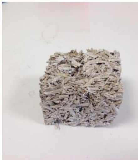
Figure 2-11 : "Cube" réalisé à partir d'un bloc industriel (70*70*70 mm)
