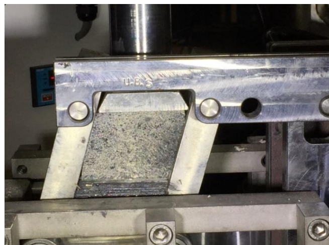
Figure 3- 51 : Essai de cisaillement M4H C \perp 2S \perp 3 avec Aramis
