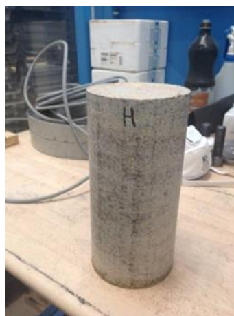
Figure 2-6 : La partie supérieure d'une éprouvette (H), Ø100 x 200 mm
