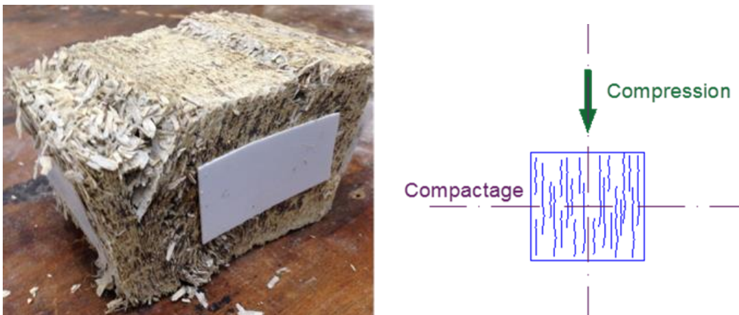
Figure 2-25: la rupture de l'éprouvette M4 en « accordéon » dans la compression parallèle ( C// ).
