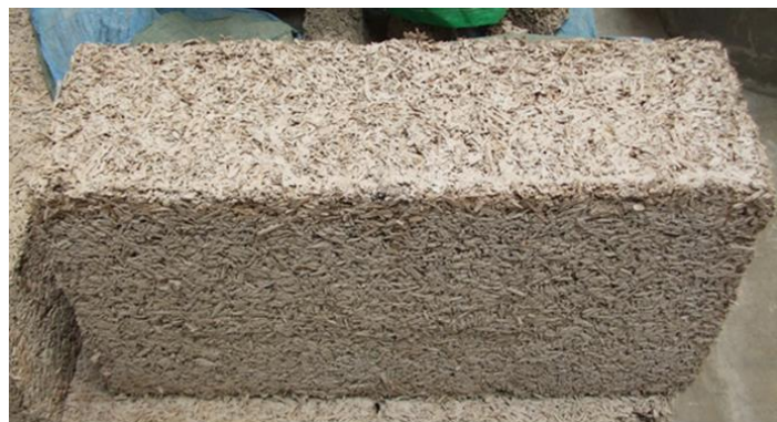
Figure 1–29: Bloc préfabriqué, « Chanvribloc» (20*30*60 cm).
