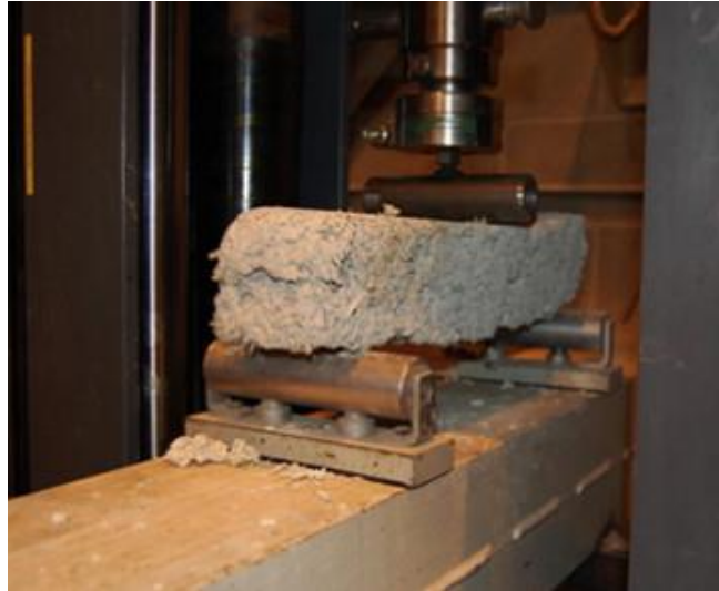
Figure 1–20: Essai sur le béton de chanvre en flexion (Walker 2014).
