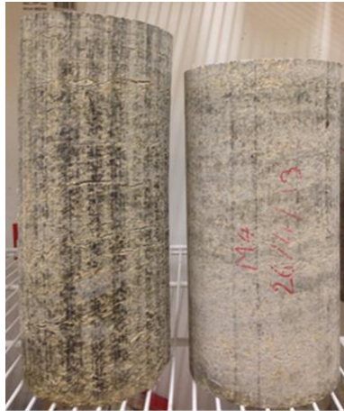
Figure 2-7 : Éprouvette M4 non confinée à gauche, éprouvette après confinement durant 3 jours à droite.
