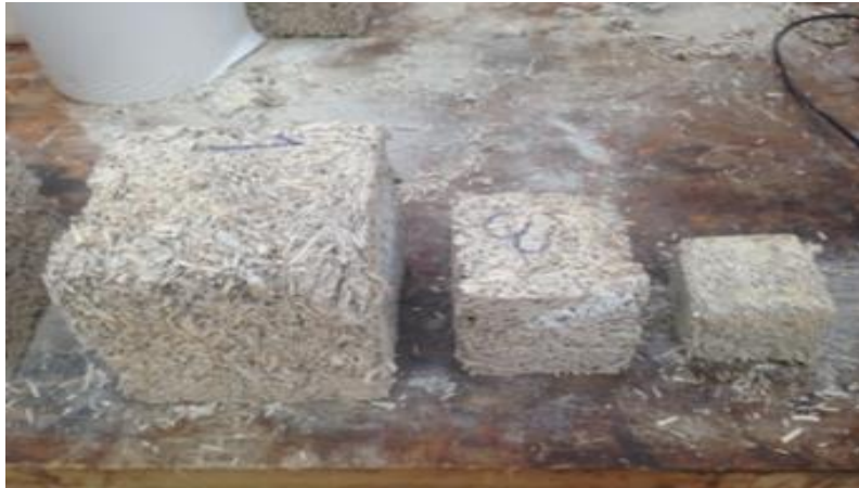
Figure 2-26: Cubes de Chanvribloc® de tailles différentes (70, 100, 150 mm)
