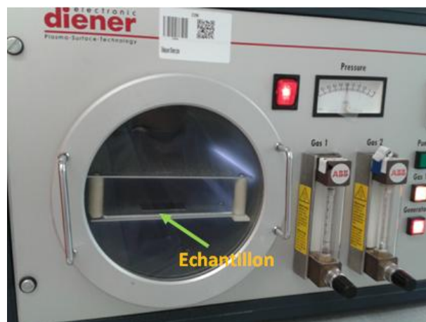
Figure 3-13: Nettoyage au plasma O_2 : les résines sont brûlées et les produits de réaction sont emportés par le flux de plasma O_2 circulant.
