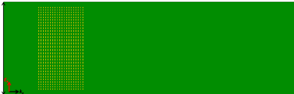
Figure 5-10 Lentille plasmonique sur un guide d'onde Si de taille 25000 \times 8000 \times 200\text{nm} . Le gradient de la longueur des CWs est : 180nm, 160nm, 140nm, 120nm et 100nm. 20 CWs forment une rangée et la répétition de rangée dans la direction transversale est 3 (6 rangées de CWs avec L=180\text{nm} au milieu de la lentille en raison de la ligne de symétrie est l'abscisse y ). La double flèche noire représente le port d'entrée.
