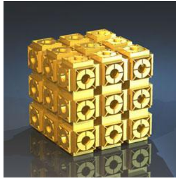
Figure 1-5 Illustration d'un modèle de MM optique à indice de réfraction négatif (photo fournie par Ames Laboratory).
