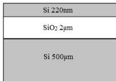
Figure 3-4: structure du substrat utilisé (vue transversale).
