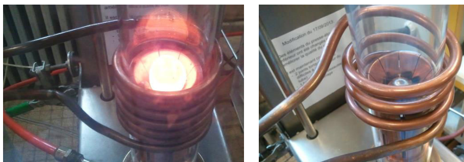
Figure B-1. Aspect de l'inducteur de la sole froide avant et après sa mise à jour.
