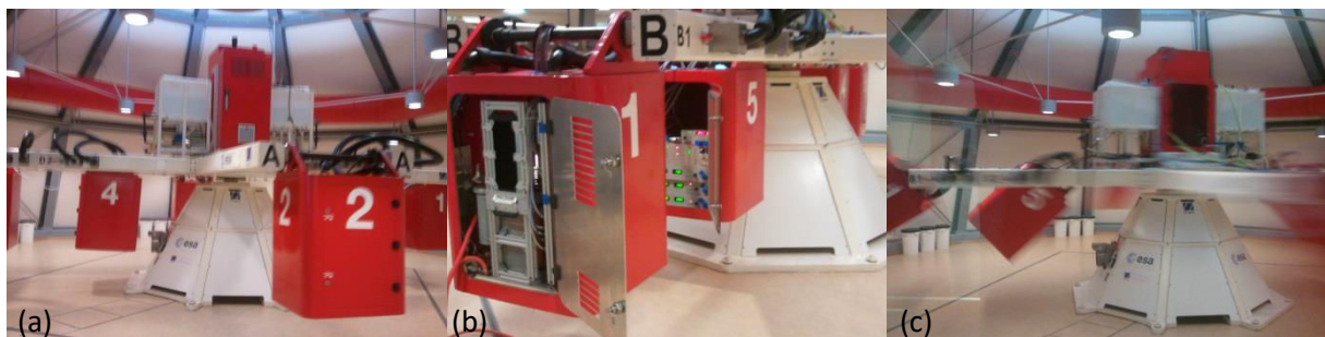
Figure 3-5. (a) Large Diameter Centrifuge, avec (b) une vue des équipements expérimentaux installés dans deux gondoles lors d'un essai et (c) une vue de la centrifugeuse en marche, en cours de décélération.
