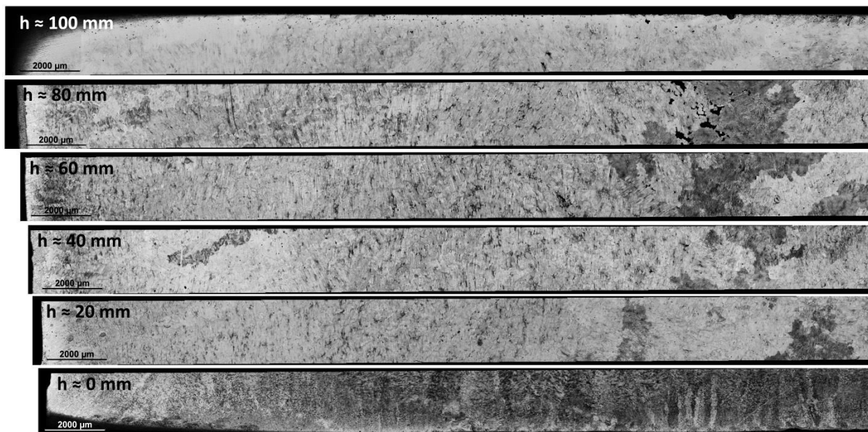
Figure 6-17. Évolution microstructurale (microscopie optique) sur la moitié du barreau : BA2, barreau court.
