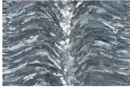
Figure 1-3. Structure en « ailes de mouette » caractéristique de certains lingots centrifugés [8].
