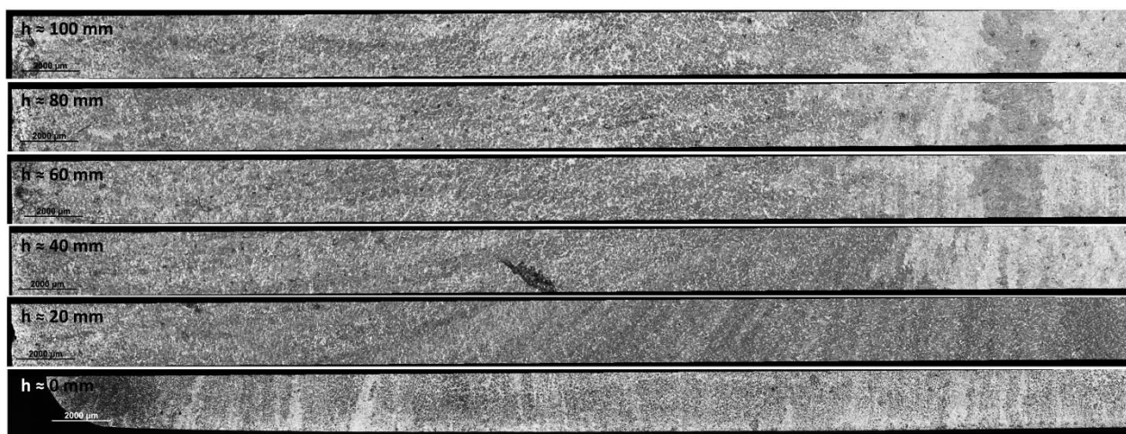
Figure 6-18. Évolution microstructurale (microscopie optique) sur la moitié du barreau : Barreau HA.
