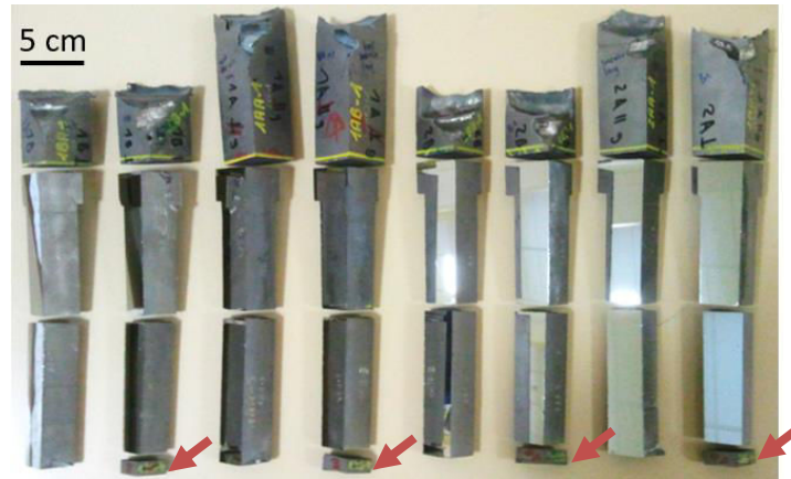
Figure 3-14. Échantillons « quarts de barreau » issus des coulées semi-industrielles, découpés et polis, avec des flèches pour indiquer les échantillons destinés à l'analyse chimique.
