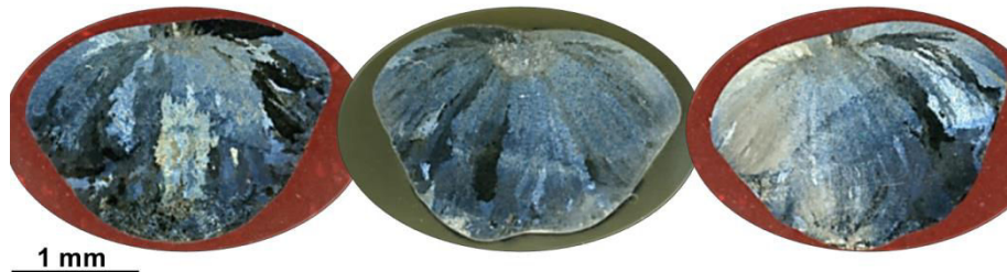
Figure 3-4. Observation au microscope optique de trois lingots issus d'essais de coulée de l'alliage Ti-47,5Al-2Cr-2Nb en creuset froid.
