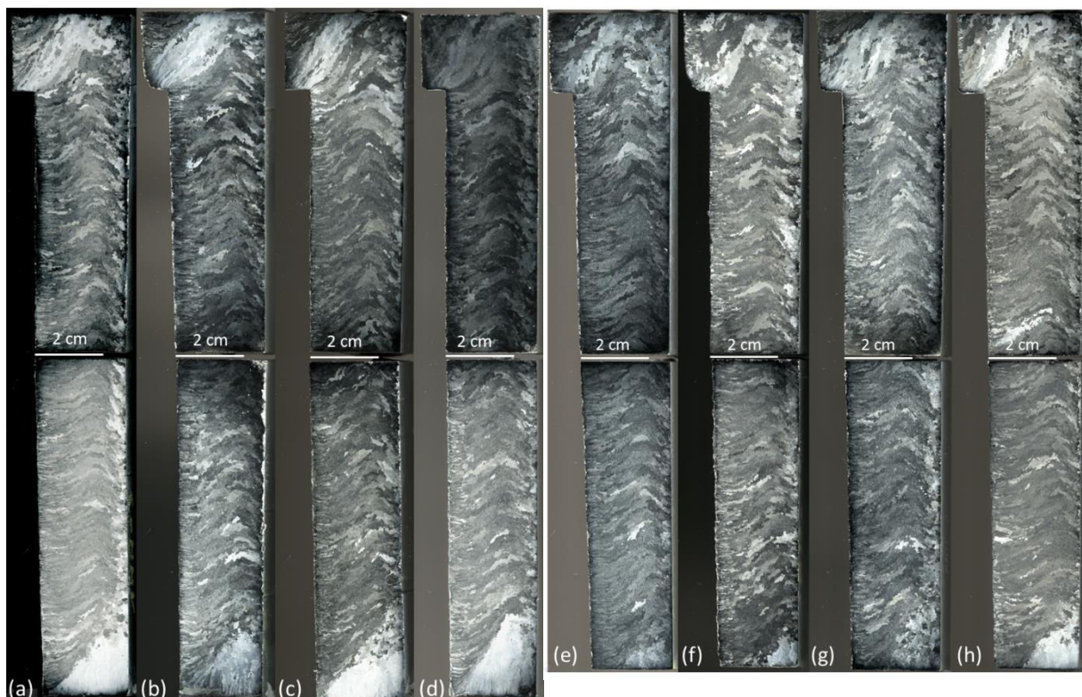
Figure 6-11. Quarts de barreau polis et attaqués, coupe \parallel g_0 : (a) BA1, barreau long ; (b) BA1, barreau court ; (c) BA2, barreau long ; (d) BA2 barreau court.
