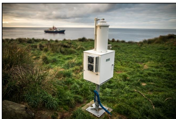
Figure 3-6: Collecteur de précipitations de type “wet only” installé à AMS. Marion Dufresne II , navire ravitailleur des TAAF, en arrière-plan. © Isabelle Juvie.
