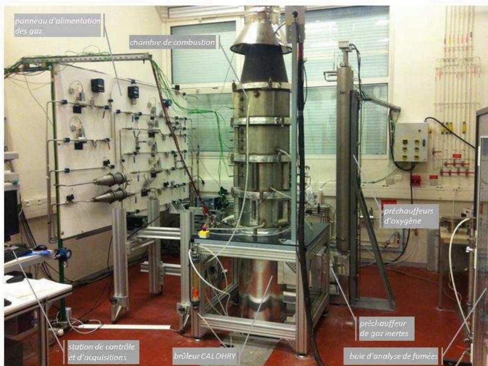
Figure 4.13 : Vue d'ensemble de l'installation pilote de laboratoire
