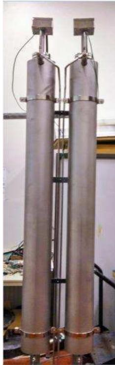
Figure 4.4 : Photographie des deux réchauffeurs oxygène
