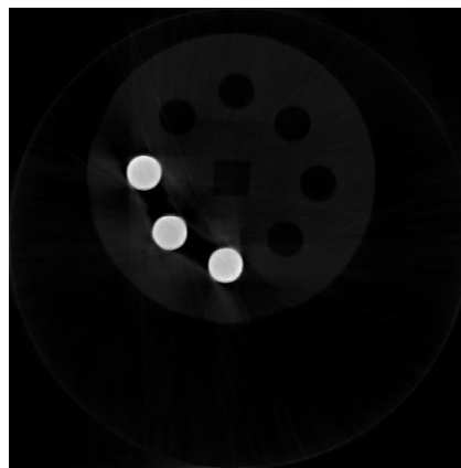
FIGURE 2.26 – Préfiltrage de l'image reconstruite pour atténuer la partie hyper-signal de l'artefact métallique.
