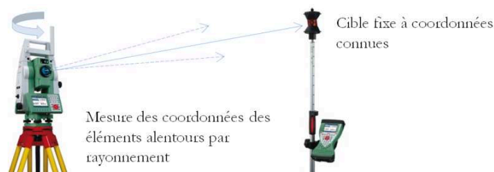
Figure 21 : Principe des levés topographiques
