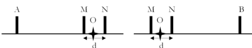
Figure 31 : Schéma du dispositif Pôle - Dipôle Pôle - Dipôle ( d = MN et AM = NB \neq d )
