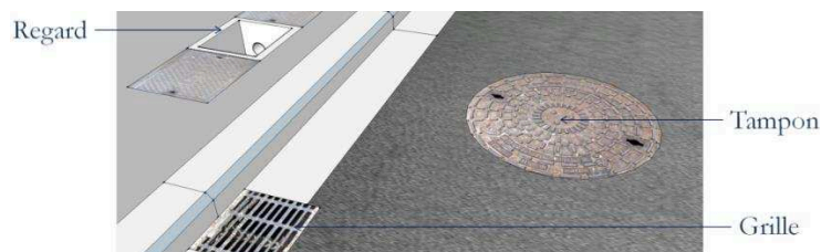
Figure 135 : Exemple de mobiliers d'un réseau d'eau visibles sur la voirie
