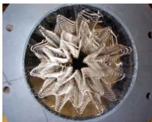
Figure 2.6 : Garnissage grillage INOX de haute porosité (Bhatia et al. , 2004)
