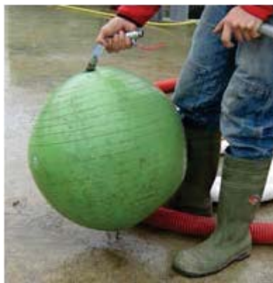
Figure 2.7 : Ballon de 70 L, soit 51 cm de diamètre utilisé pour la calibration des compteurs à gaz
