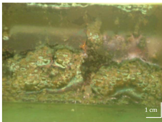
Figure 3.16 : Photographie du précipité formé en surface du bac de stockage d'eau
