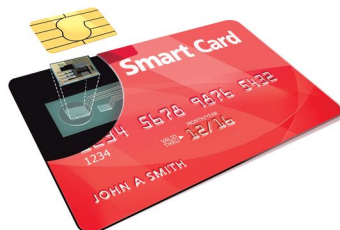
FIGURE 2.7 – Vue éclatée sur un SE de type carte à puce.
