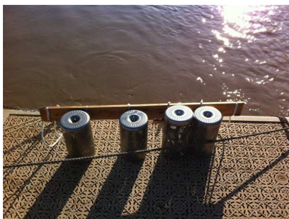
Figure 54. Jeux de POCIS exposés sur le site de Cadaujac pour la validation in situ .
