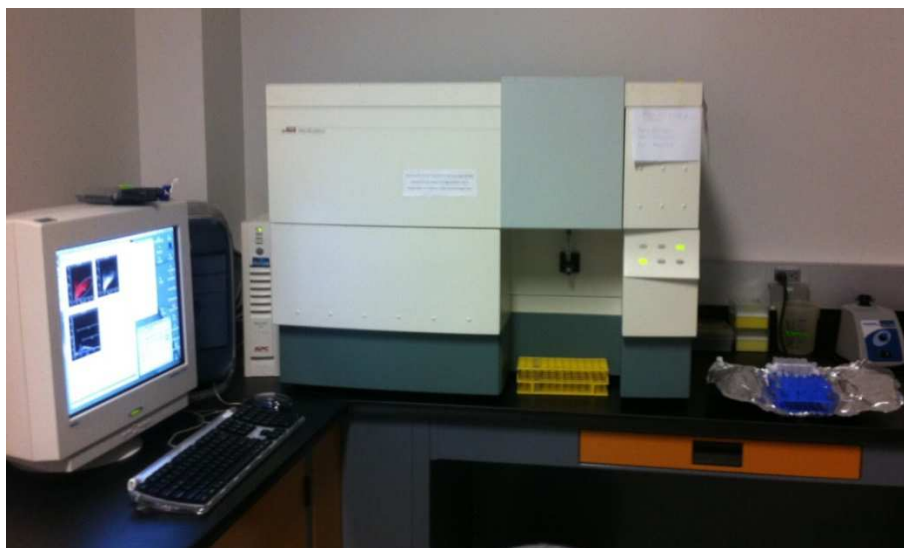
Figure 63. Photo du cytomètre de flux (FACScalibur) utilisé lors de ces travaux de thèse.
