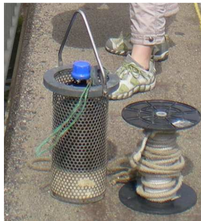
Figure 38. Préleveur manuel lesté contenant une bouteille de 2,5 L en verre ambré.
