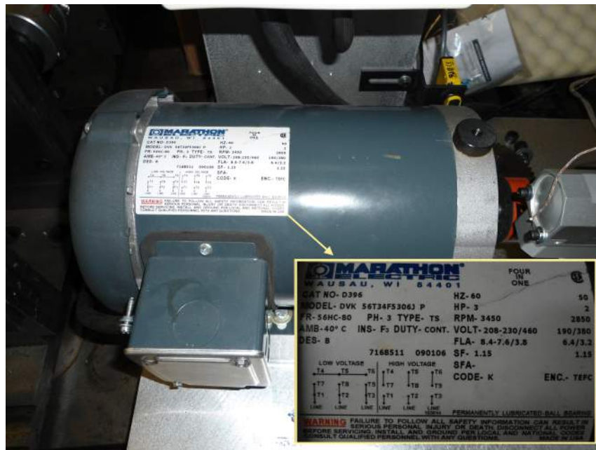
FIGURE A.4 – Le moteur asynchrone de Spectra-Quest.
