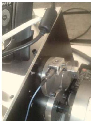
FIGURE A.2 – Position de l'accéléromètre.
