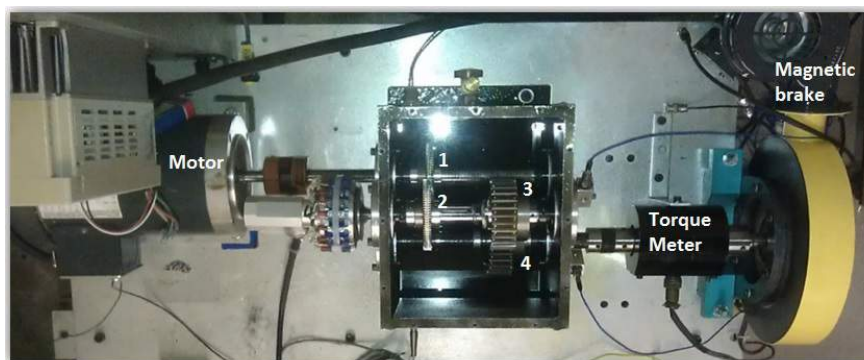
FIGURE 5.2 – Le banc d'engrenages Spectra-Quest après les modifications.
