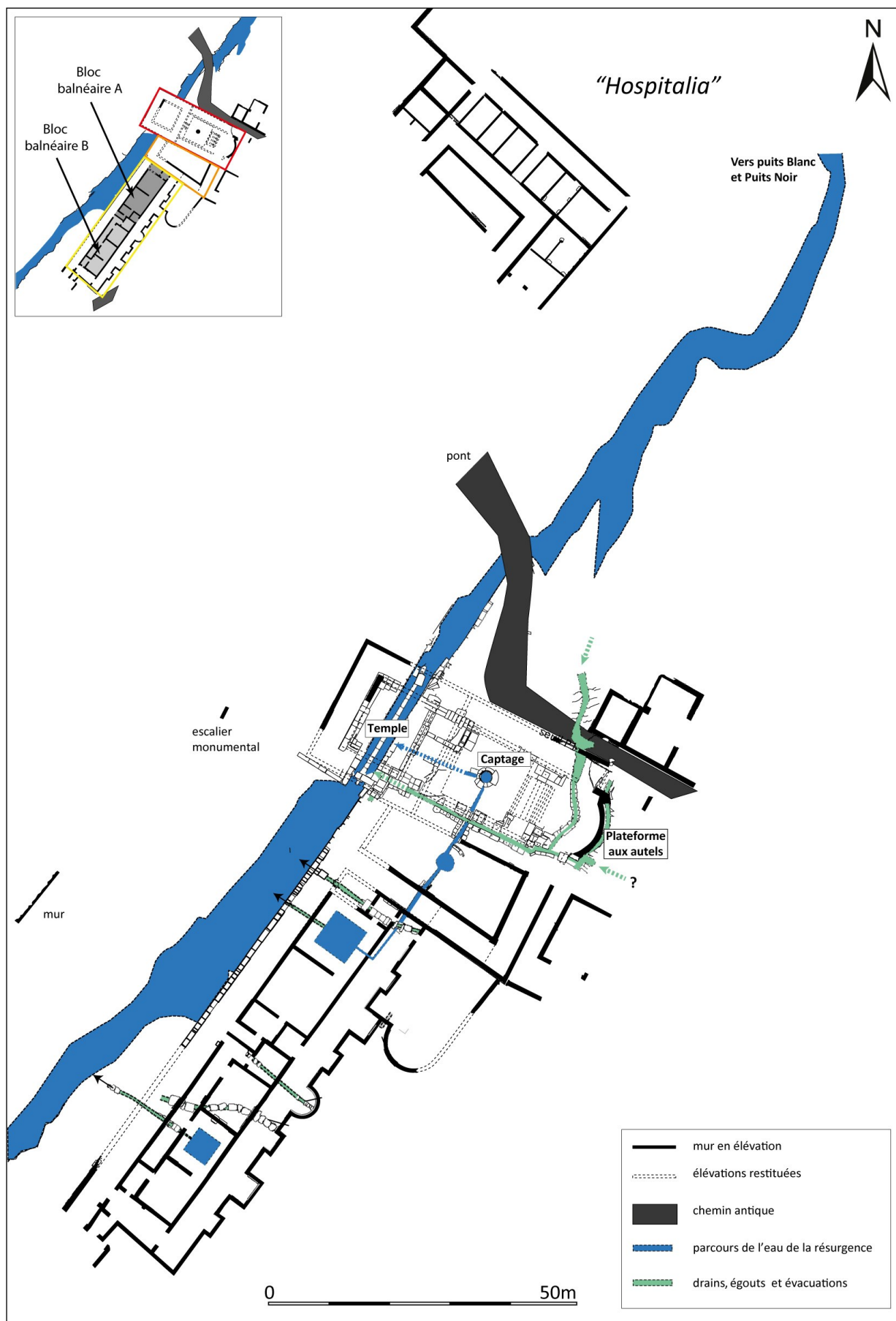
Figure 93 : Plan général de l'organisation et de la circulation de l'eau au sein du site du Pont-des-Arches (DAO D. Vurpillot et P. Nouvel 2014).
