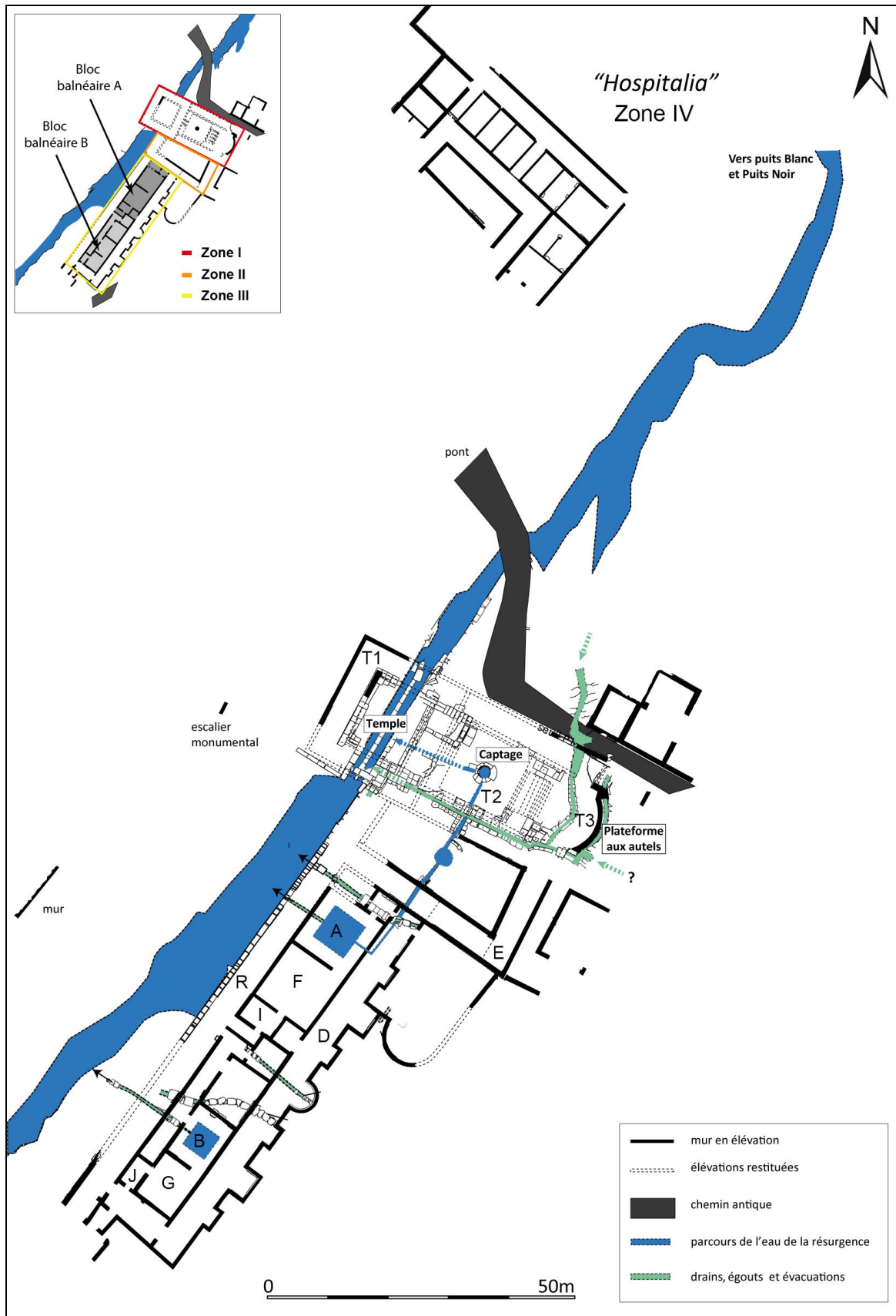
Figure 30 : Plan général de l'organisation et de la circulation de l'eau au sein du site du Pont-des-Arches (DAO D. Vurpillot et P. Nouvel 2014).
