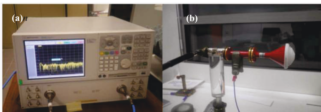
Figure II.8. Partie émettrice. (a) VNA. (b) Antenne cornet avec lentille de Fresnel.
