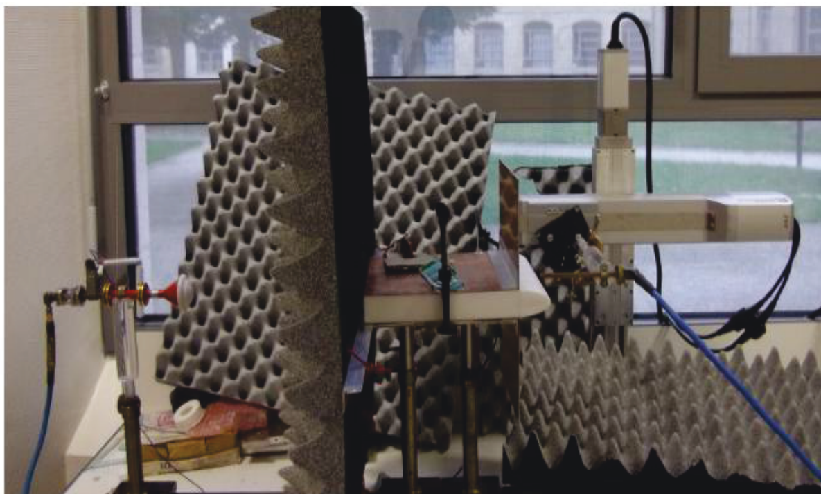
Figure II.7. Photo du dispositif expérimental pour la mesure du jet EM en sortie du guide d'onde
