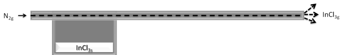
Figure 3.27 - Schéma de la source 2 d'indium mise en place à l'Institut Pascal.
