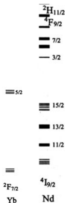
Fig. 3.17 : Diagramme partiel des niveaux d'énergie de l'ytterbium et le néodyme [66] .
