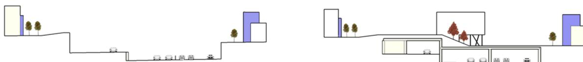
FIG. 2.2 – Coupes d'une infrastructure de transport en milieu urbain, avant et après couverture
