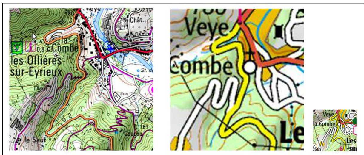
Figure 1 Deux extraits de carte IGN : à gauche, carte conçue pour l'échelle 1 : 25000 ; au milieu carte conçue pour l'échelle 1 : 100 000, avec une taille agrandie pour que la même zone soit représentée sur le papier sur une surface de même taille ; à droite, le même extrait aux proportions réelles par rapport à l'extrait de gauche.
