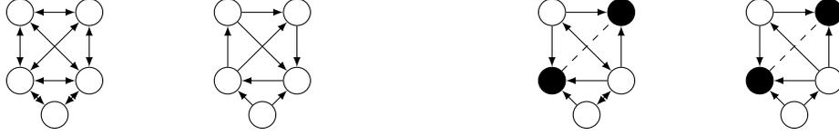
(a) graphe sans panne avec  $D^+(\vec{G}) = 4$  et  $D_{opt}^+(\vec{G}) = 2$  et (b) graphe avec 2 pannes avec  $D^+(\vec{G}_F) = 3$  et  $D_{opt}^+(\vec{G}_F) = 3$
