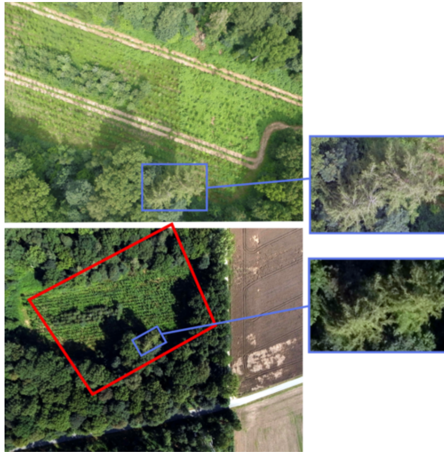
FIGURE 5: Illustration de la résolution et de la largeur de la fauchée pour deux images capturées avec le Ricoh GRIII. A des fins de cartographie forestière, il est préférable d'acquérir des images à moins bonne résolution mais avec une plus grande fauchée, avec donc plus d'objets présents sur l'image. La première image en haut est une prise de vue à 100 mètres d'altitude : la résolution y est de 3.4 cm/pixel et la largeur de la fauchée est de 125 mètres. La deuxième image en bas est une prise de vue à 225 mètres, de 6.8 cm/pixel et d'une emprise de 275 mètres de large. En rouge sur l'image du bas, les limites de la fauchée de l'image du haut.
