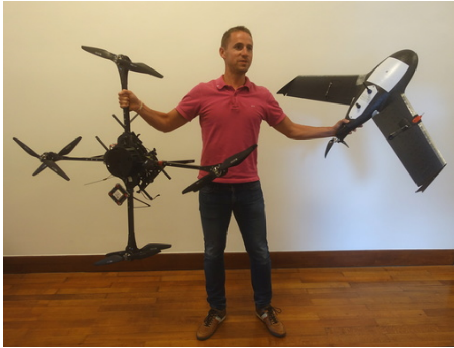
FIGURE 2: Les deux catégories les plus courantes de châssis drones sont les drones à voilure tournante (drone à rotors de type hélicoptère) et les drones à voilure fixe (type aile volante ou planeur). Sur l'image à droite, le modèle Gatewing X100 et à gauche, le modèle GX8.
