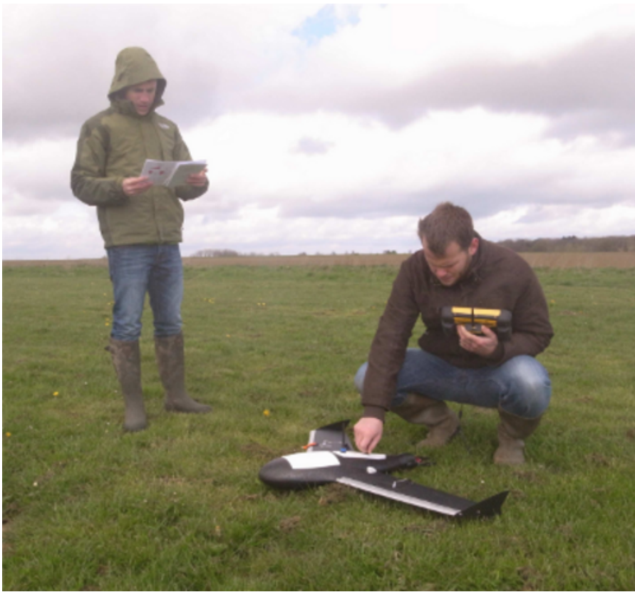
FIGURE 12: Les deux pilotes à distance récupèrent le drone Gatewing X100 après un atterrissage. Le pilote de gauche tient la liste de vérification des opérations et le pilote de droite effectue les opérations, tantôt sur le drone, tantôt sur la station de contrôle au sol qu'il tient à la main.
