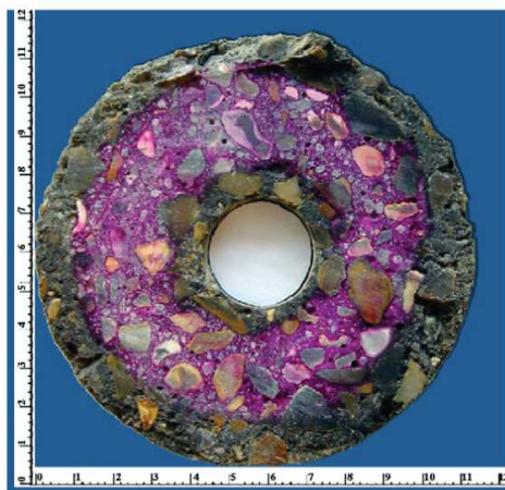
FIGURE A.3 – Mise en évidence du phénomène de lixiviation (résultat expérimental de [90]). La partie en rose représente la partie n'ayant pas encore réagi au bout de 36 jours.
