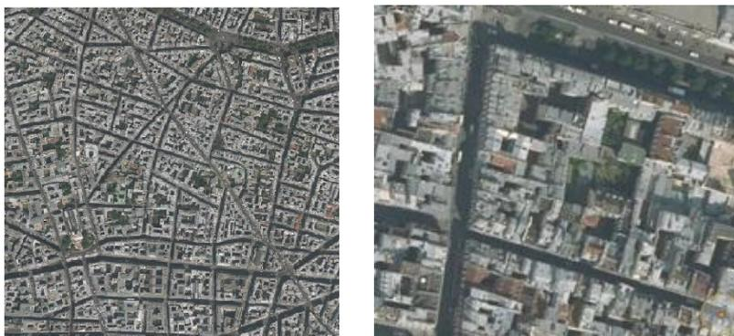
**Figure 3.29 : Différence entre une maille de 1km<sup>2</sup> (à gauche) et d'une maille de 100\*100m (à droite) (extrait Orthophotographies RGE®IGN)**
