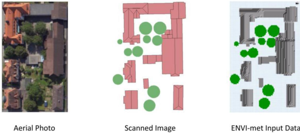
Figure 1.31 : Exemple de photo aérienne (orthophotos), images scannées et représentation dans le logiciel ENVI-net. Source : Youssef, 2010
