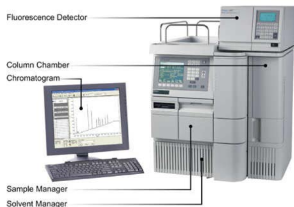
FIGURE 1.37 – Exemple de machine de chromatographie à haute performance. Mise en évidence des principaux organes : la colonne de mélange, les supports des solvants et échantillons, le détecteur et le traitement de l'information, d'après [79].
