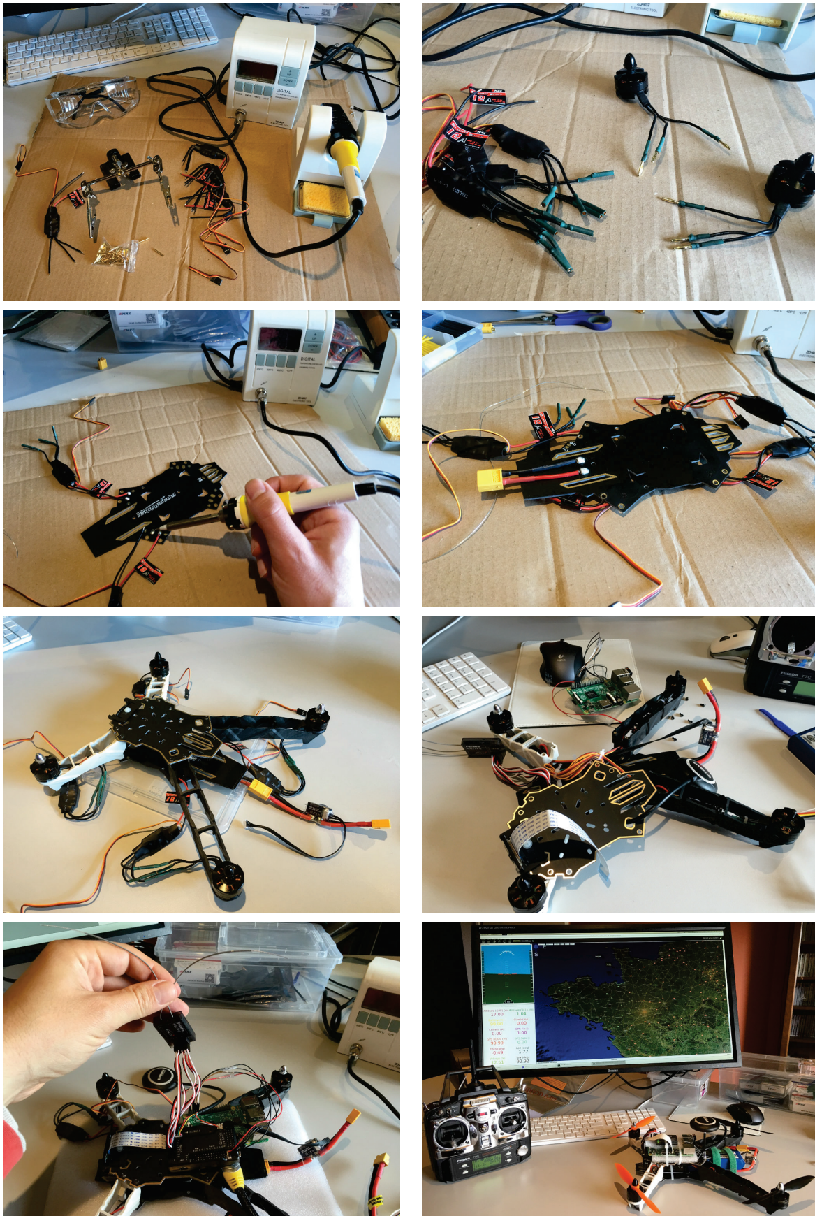
FIGURE 7.3 – De haut en bas, de gauche à droite : (a) et (b) pose des connecteurs des ESC et des moteurs, (c) pose des ESC, (d) pose du connecteur de batterie, (e) pose des moteurs, (f) connexion du SoC Raspberry, de sa caméra et du GPS, (g) pose du récepteur de radiocommande, (h) tests de transmission de l’UAV monté vers le logiciel de commande au sol.
