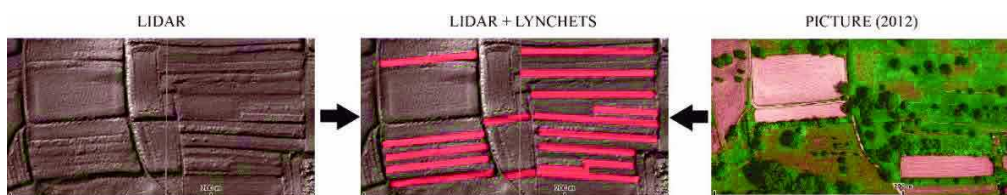
Figure 5.2 : Etapes d'identification des rideaux de culture à partir du LIDAR et des photos aériennes (Alsace/Haut-Rhin/68) ; Données: InfoGéo68 ; Source : Lucie Froehlicher
