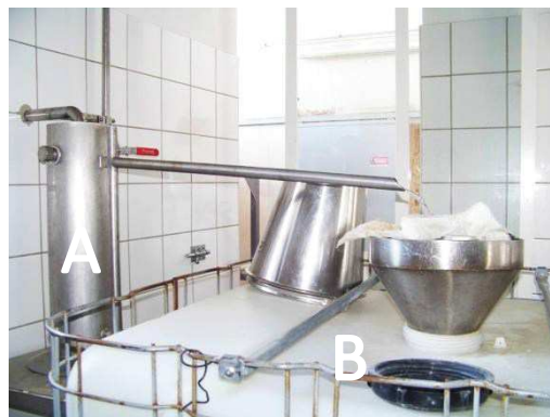
Photographie 13 (à gauche) : réfrigérant. Photographie 14 (à droite) : A : essencier dans lequel sont séparés l'hydrolat et l'huile essentielle ; B : cuve de transfert munie d'un entonnoir. Photographies : C. Labadie – Albert Vieille SAS
