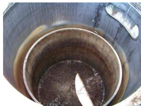
Photographie 11 (à gauche) : cueillette de la rose de mai dans un sac en toile de jute. Photographie : Albert Vieille SAS. Photographie 12 (à droite) : cuve de distillation avec la grille sur laquelle on dépose les roses fraîches en vue de la distillation. Photographie : C. Labadie – Albert Vieille SAS
