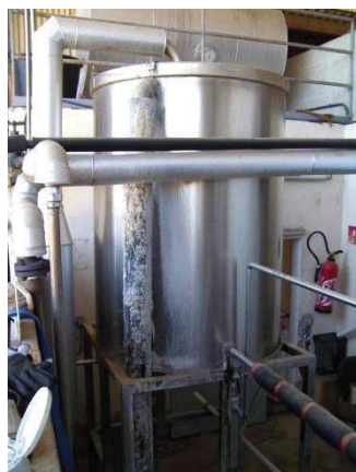
Photographie 13 (à gauche) : réfrigérant. Photographie 14 (à droite) : A : essencier dans lequel sont séparés l'hydrolat et l'huile essentielle ; B : cuve de transfert munie d'un entonnoir. Photographies : C. Labadie – Albert Vieille SAS
