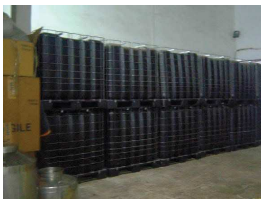
Photographie 4 (à gauche) : Le pasteurisateur en E et la cuve de transfert en F. Photographie 5 (à droite) : cubitainers de capacité 1000L. Photographies : C. Labadie – Albert Vieille SAS
