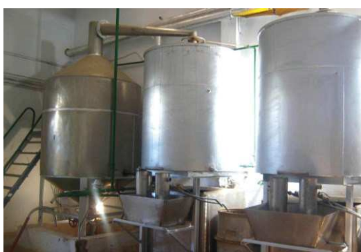
Photographie 7 (à gauche): cuves de distillation. Photographie 8 (à droite): système de chauffe d'une cuve de distillation (tubulure). Photographies : C. Labadie – Albert Vieille SAS
