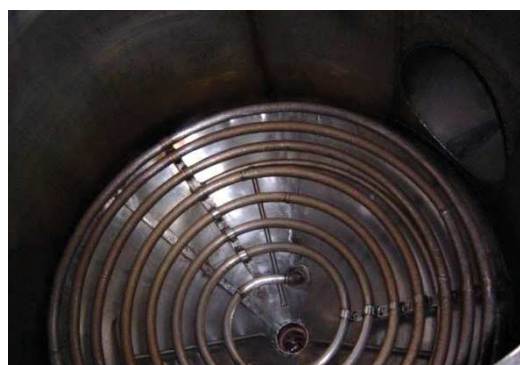
Photographie 7 (à gauche): cuves de distillation. Photographie 8 (à droite): système de chauffe d'une cuve de distillation (tubulure). Photographies : C. Labadie – Albert Vieille SAS
