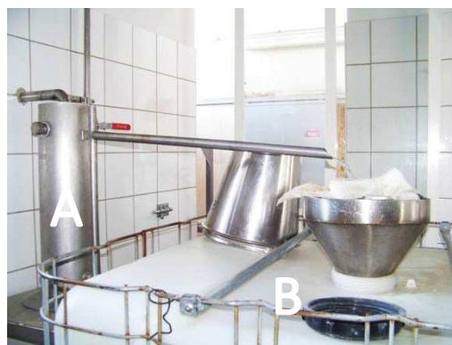
Photographie 13 (à gauche) : réfrigérant. Photographie 14 (à droite) : A : essencier dans lequel sont séparés l'hydrolat et l'huile essentielle ; B : cuve de transfert munie d'un entonnoir. Photographies : C. Labadie – Albert Vieille SAS
