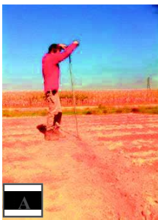
Image 3.13 : Les différentes étapes qui composent un suivi gravimétrique avec : le prélèvement de sol à l'aide d'une tarière manuelle [A], l'arasement de l'échantillon pour éviter toute contamination [B], la pesée du sol dès sa mise en barquette aluminium [C] et l'étuvage pour la pesée de la masse de sol sec [D].
