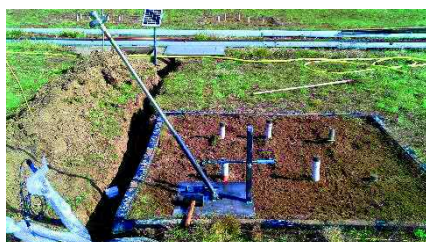
Image 2.12 : Mise en place de la centrale d'acquisition dans le Regard 1 et implantation des cinq tensiomètres T4e à la place des tensiomètres à capteurs piézométriques.
