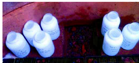
Image III : Disposition des contenants dans un des regards où l'eau de drainage est collectée.
