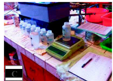
Image 3.5 : Détermination de la conductivité hydraulique à saturation au laboratoire par mesure du niveau d'eau à l'aide d'une règle puis pesée du volume écoulé au cours de la manipulation.
