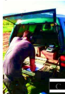
Image 3.13 : Les différentes étapes qui composent un suivi gravimétrique avec : le prélèvement de sol à l'aide d'une tarière manuelle [A], l'arasement de l'échantillon pour éviter toute contamination [B], la pesée du sol dès sa mise en barquette aluminium [C] et l'étuvage pour la pesée de la masse de sol sec [D].
