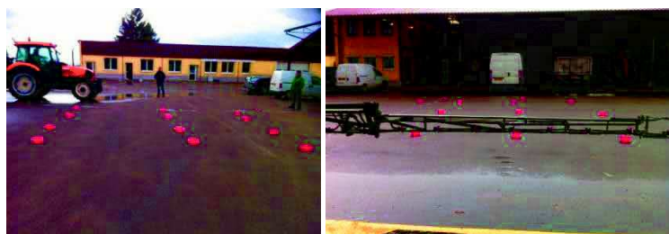
Image III: Mise en place des tests pour l'estimation de la lame d'eau apportée sur les parcelles, au travers du quadrillage à l'aide de bassines d'une surface sensiblement équivalente.
