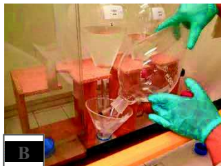
Image VIII : Procédure d'extraction liquide/liquide des échantillons d'eau de drainage contenant le chloroforme et la lame d'eau ultra pure ajoutée en amont.
