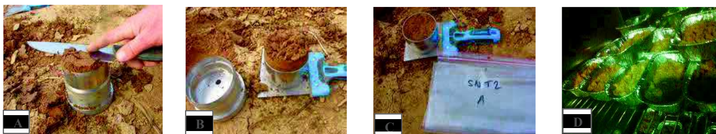
Image 3.7 : Détermination des masses volumiques apparentes : arasement de la terre sur chaque bord du cylindre [A et B] et mise en sachet Cryovac ou en barquette en aluminium pour étuvage [C et D].
