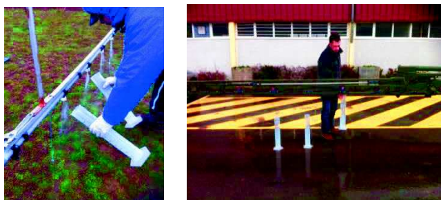
Image II : Détermination du volume d'eau débité par les buses à l'aide d'éprouvettes graduées.
