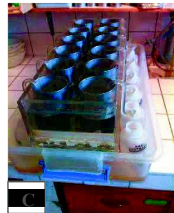
Image 3.4 : Étapes de préparation des échantillons avant analyse pour la détermination au laboratoire de la conductivité hydraulique à saturation d'échantillons de sol non remaniés.
