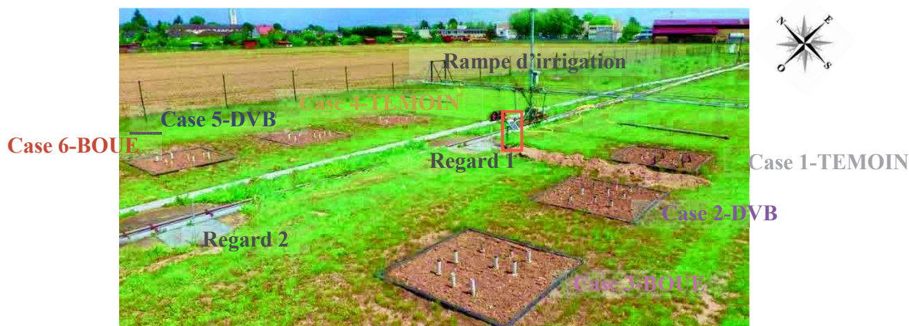
Image 2.9 : Dispositif des six cases lysimétriques (et code couleur associé), regards où sont récupérés l'eau de drainage et les données acquises par les instruments et rampe permettant l'irrigation.
