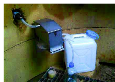
Image 2.14 : Système de récupération de l'eau de drainage : compteur de débit, échantillonnage principal (30 L) et sous-échantillonnage (2 ou 5 L).
