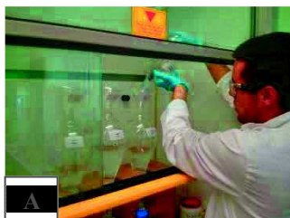
Image VIII : Procédure d'extraction liquide/liquide des échantillons d'eau de drainage contenant le chloroforme et la lame d'eau ultra pure ajoutée en amont.
