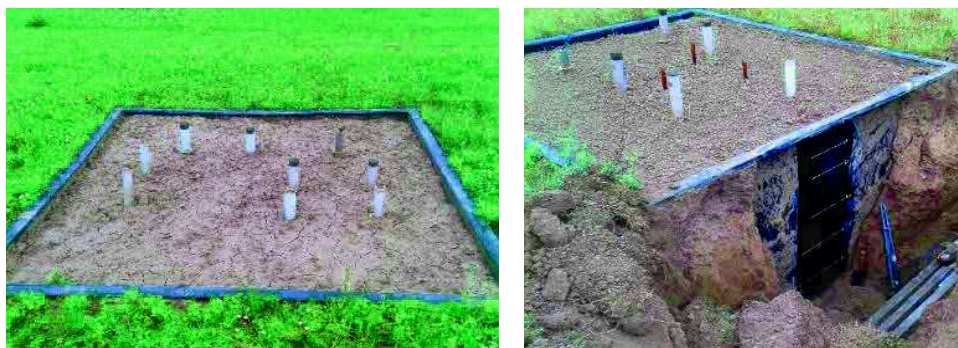
Image 2.7 : Case lysimétrique intégrée au dispositif expérimental de la plateforme PRO.
