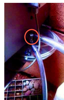
Image 3.10 : Vis permettant d'ajuster les quantités d'eau sous-échantillonnées.
