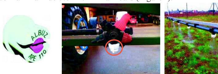
Image I : Buse APE 110° (ALBUZ®) utilisée pour l'apport d'ions bromures sur les parcelles et les cases lysimétriques.
