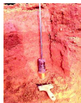
Image 3.1 : Prélèvement des échantillons destinés à l'établissement des courbes de rétention en eau.
