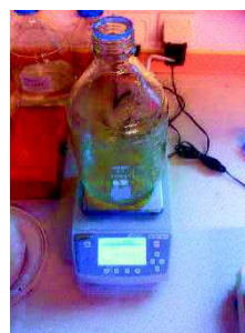
Image II : Pesée d'un flacon et calcul du \text{CHCl}_3 volatilisé entre deux dates.
