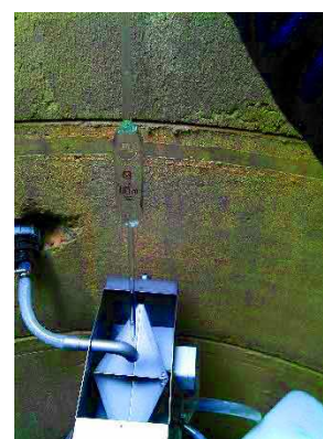
Image 3.9 : Étalonnage d'un auget à l'aide d'une pipette jaugée de 100 mL.
