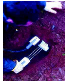
Image IV : Procédure d'instrumentation des sondes TDR.
