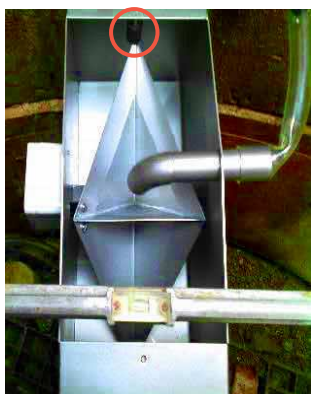
Image 3.8 : Auget d'un compteur de débit et « bumper » (en rouge) permettant son étalonnage.
