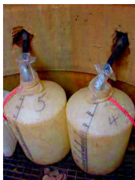
Image 2.13 : Bidons de récupération (60 L) de l'eau de drainage des cases en place jusque mars 2013.
