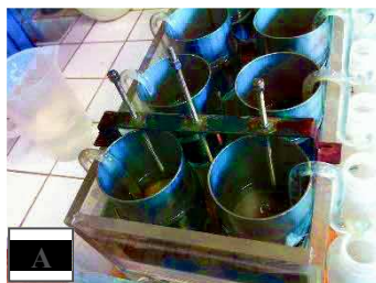
Image 3.5 : Détermination de la conductivité hydraulique à saturation au laboratoire par mesure du niveau d'eau à l'aide d'une règle puis pesée du volume écoulé au cours de la manipulation.
