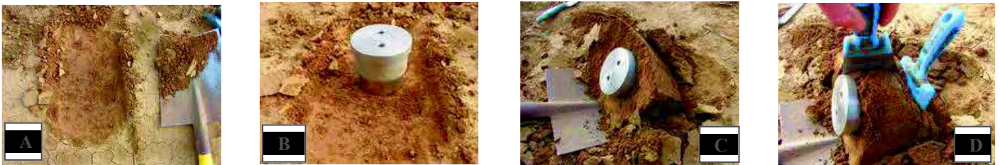
Image 3.6 : Détermination des masses volumiques apparentes : excavation des premiers centimètres de terre et mise à niveau [A], positionnement du cylindre sur le sol [B] et prélèvement à l'aide d'une bêche [C] et de spatules [D].
