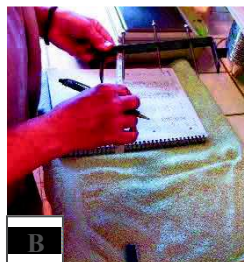
Image 3.5 : Détermination de la conductivité hydraulique à saturation au laboratoire par mesure du niveau d'eau à l'aide d'une règle puis pesée du volume écoulé au cours de la manipulation.
