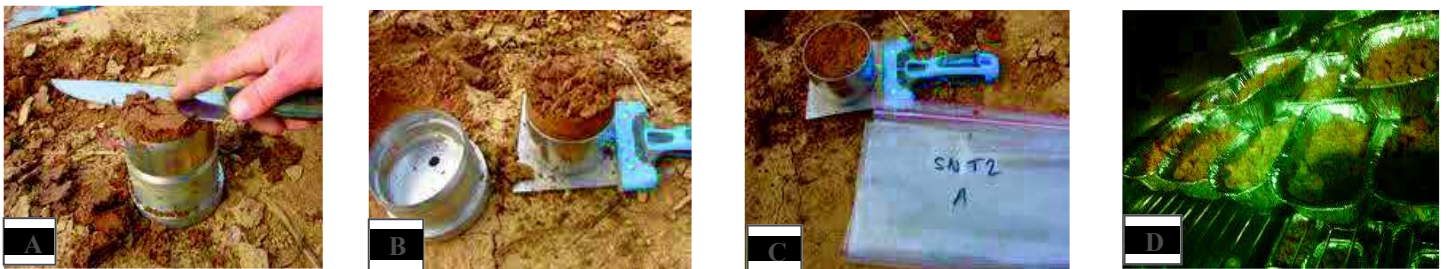
Image 3.7 : Détermination des masses volumiques apparentes : arasement de la terre sur chaque bord du cylindre [A et B] et mise en sachet Cryovac ou en barquette en aluminium pour étuvage [C et D].
