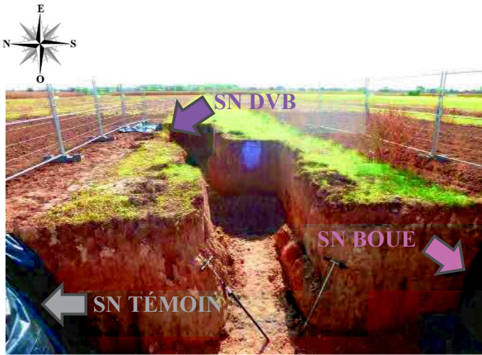
Image 2.4 : Fosse d'instrumentation et positionnement géographique des trois parcelles en sol nu.
