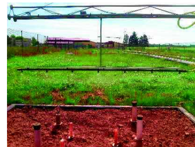
Image 2.8 : Rampe permettant l'irrigation sur les cases lysimétriques.
