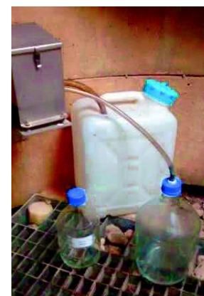
Image IX : Bidon collecteur principal (20 L) et flacons de 2 et de 5 L destinés au sous-échantillonnage de l'eau de drainage.
