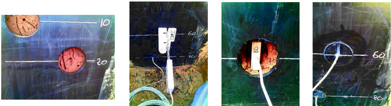
Image 2.15 : Mise en place des sondes TDR CS605 après la réalisation d'un trou dans la paroi de la Case 4 (01/08/2013).
