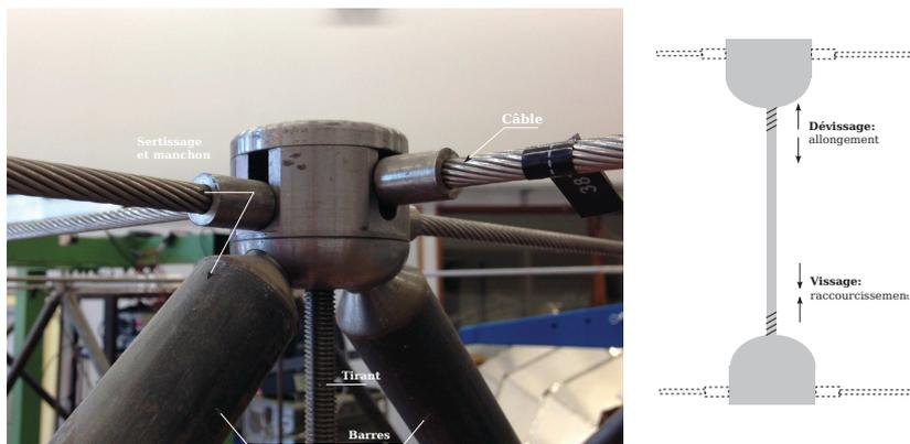
FIGURE 4.4 – Nœud de la grille, assemblage des éléments
