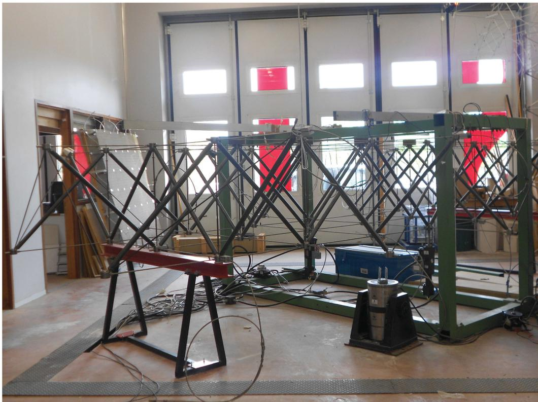
FIGURE 4.1 – Grille de tensegrité active issue du projet Tensarch [MOT 02]
