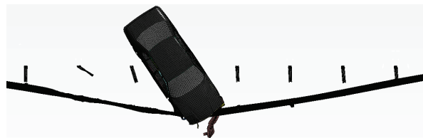
Figure A- 16 Échec de la réorientation du véhicule : H et E diminuent considérablement
