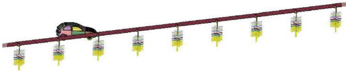
Figure A- 4 Un modèle d'essai de choc de la barrière [15]
