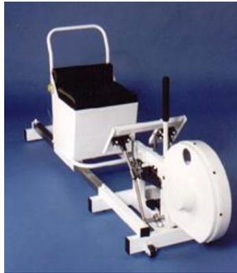
Figure 35 : Nottingham Power Rig pour l'évaluation de la puissance d'extension du membre inférieur
