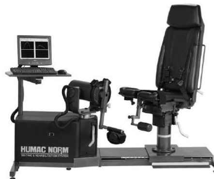
Figure 34 : Cybex Norm® pour l'évaluation de la flexion et de l'extension du genou.
