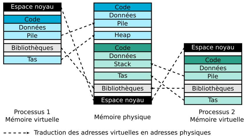
FIGURE 1.2 – Virtualisation de la mémoire des applications sous les systèmes Unix
