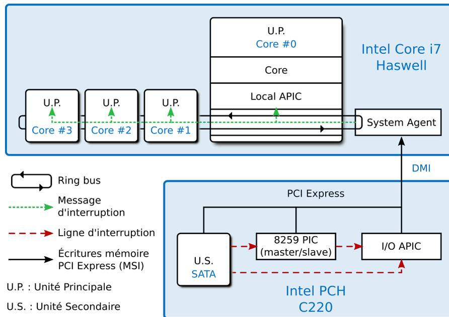
FIGURE 2.2 – Mécanismes internes de gestion des interruptions
