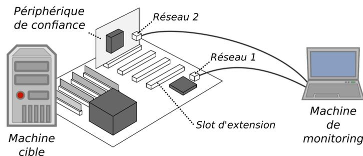
FIGURE 3.2 – Plateforme de l'architecture de sécurité
