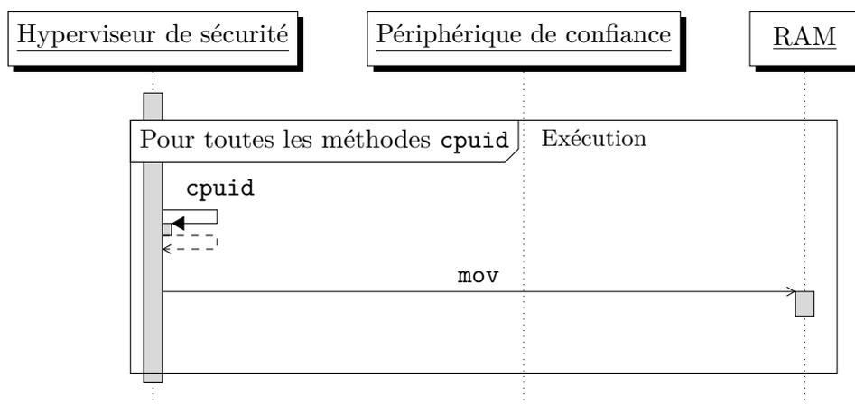
FIGURE 3.8 – Exécution nominale d'un challenge simple CPUID
