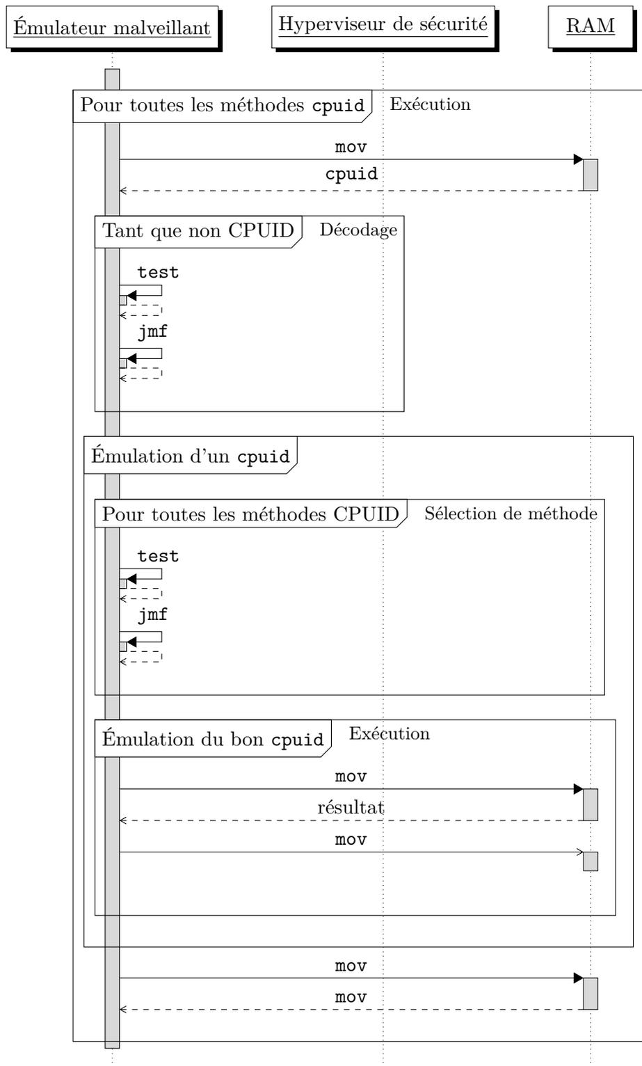
FIGURE 3.10 – Exécution virtualisée d'un challenge simple CPUID
