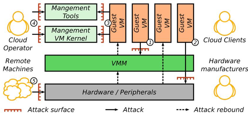
FIGURE 1.9 – Modèle de menaces d'une machine hôte
