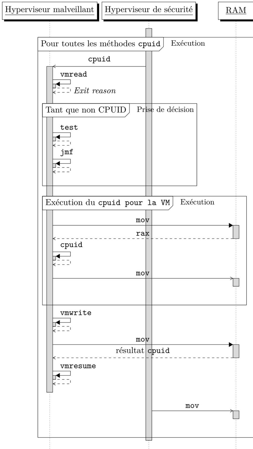
FIGURE 3.9 – Exécution virtualisée d'un challenge simple CPUID
