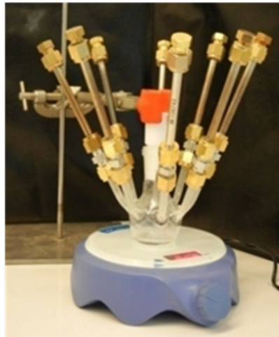
Figure 43 : Système de ballon à 8 branches permettant l'exposition des filtres Quartz à la PFBHA pendant 40h à température ambiante
