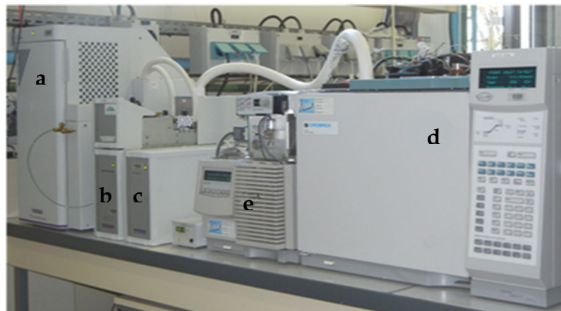
Figure 38 : Système analytique utilisé au cours de ce travail de thèse (a) Passerelle d'échantillon Ultra 50 :50 ; (b) Thermo-désorbeur Unity 1 ; (c) Débitmètre massique ; (d) Chromatographe en phase gazeuse Agilent modèle 6890A ; (e) Spectromètre de masse Agilent modèle 5973N
