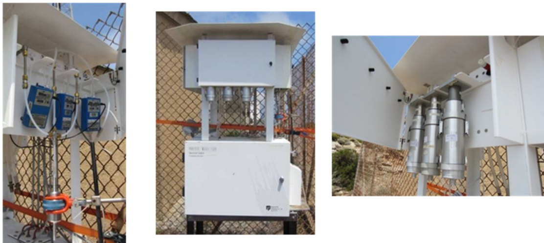
Figure 36 : (gauche) Système de piégeage de la phase gazeuse sur tubes Tenax TA avec l'emploi de pompes Gilian® ; (milieu) Partisol Spéciation, modèle 2300 ; (droite) Cartouches ChemComb® utilisées pour le prélèvement de la phase particulaire sur filtres
