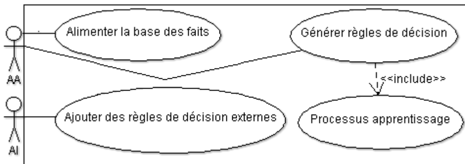
Figure II.30. Diagramme des cas d'utilisation du sous-système d'apprentissage
